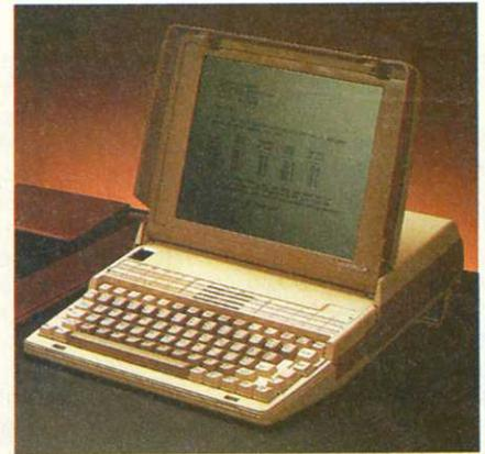
permettant l'accès à des ordinateurs centraux grâce au réseau téléphonique et une batterie intégrée au nickel-cadmium donnant une autonomie de 10 heures en fonctionnement continu. Un logiciel spécifique baptisé Connexion CEO permet l'échange de documents et de fichiers créés par Wordstar ou Multiplan entre l'ordinateur Data General One et le système de bureautique intégré CEO de Data General.
